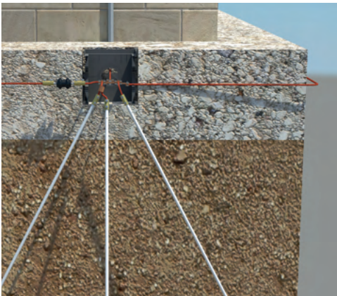
Fig. 13 – Secção transversal de uma ligação à terra.
