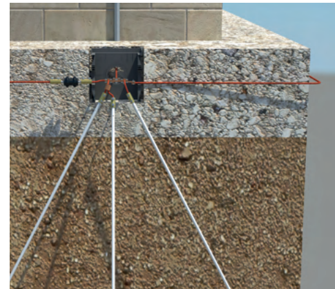
Fig. 13 – Sección transversal de una puesta a tierra.
