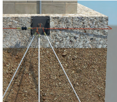
Fig. 13 – Coupe transversale d'une mise à la terre.
